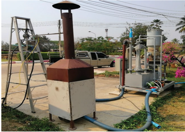
ภาพที่ 1 เตาแก๊สซีฟิเออร์แบบไหลลงและระบบทำความสะอาดโปรติวเซอร์แก๊ส
